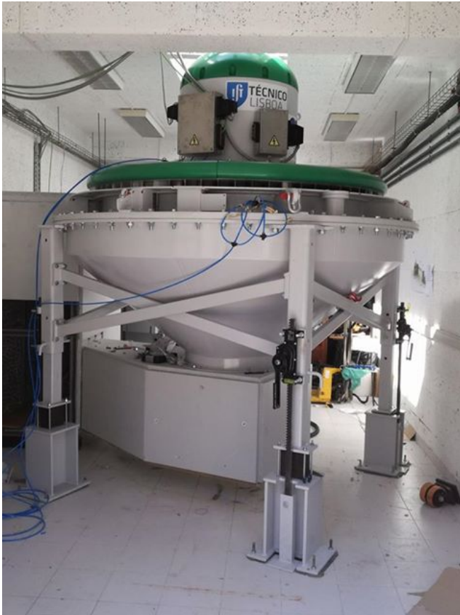
Fig. 3. Biradial turbine installed at the IST variable-flow turbine test rig.
